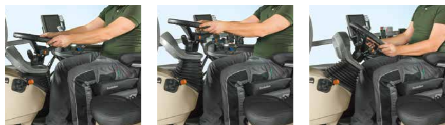
Para total conforto operacional, o cockpit se desloca juntamente com o volante da direção.
