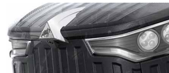
As luzes de circulação diária em LED e as luzes de trabalho estão integradas na frente do capô, que inclui uma câmera.
