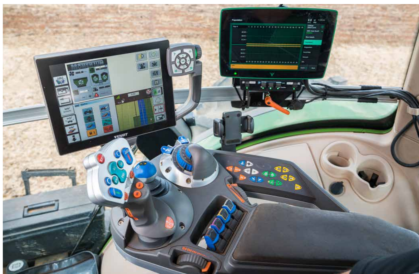
Em modo de condução reversível, todos os elementos de controle podem ser operados de forma tão confortável como em modo de condução para a frente. Toda a estação de condução é rotacionada de uma simples a 180°. Todo o resto da cabine mantém-se na mesma posição. Tudo a bordo do assento conforto.
