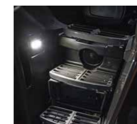
A iluminação integrada dos degraus de entrada ao lado do depósito de combustível garante uma entrada e saída em segurança.
