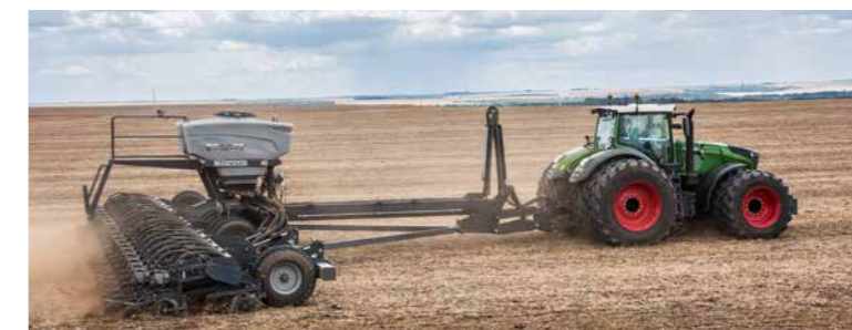
Graças ao sistema de gestão do trator TMS e ao controle automático de potência máxima 2,0, o trator adapta o regime do motor perfeitamente à velocidade de circulação.
